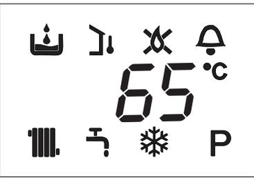
1 Visualizzatore digitale che segnala la temperatura di funzionamento e i codici anomalia
