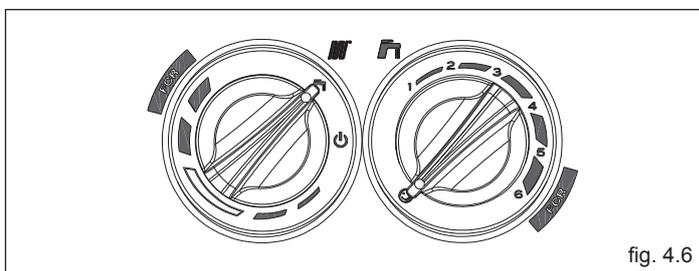
Per disattivare la funzione preriscaldamento ruotare nuovamente la manopola regolazione temperatura acqua sanitaria sul simbolo ☺. Riportare la manopola di regolazione temperatura acqua sanitaria nella posizione desiderata. La funzione non è attiva con caldaia in stato OFF: selettore di funzione su ⏻ spento (OFF) (fig. 4.1a).
