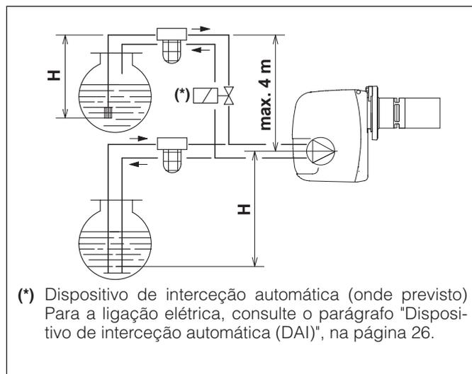
**!** Caso seja prevista a instalação de uma eletroválvula de consenso no circuito de alimentação de gásóleo ao queimador, instalar exclusivamente sistemas do tipo monotubo. Uma possível conexão bitubo pode comprometer o funcionamento correto do queimador.
