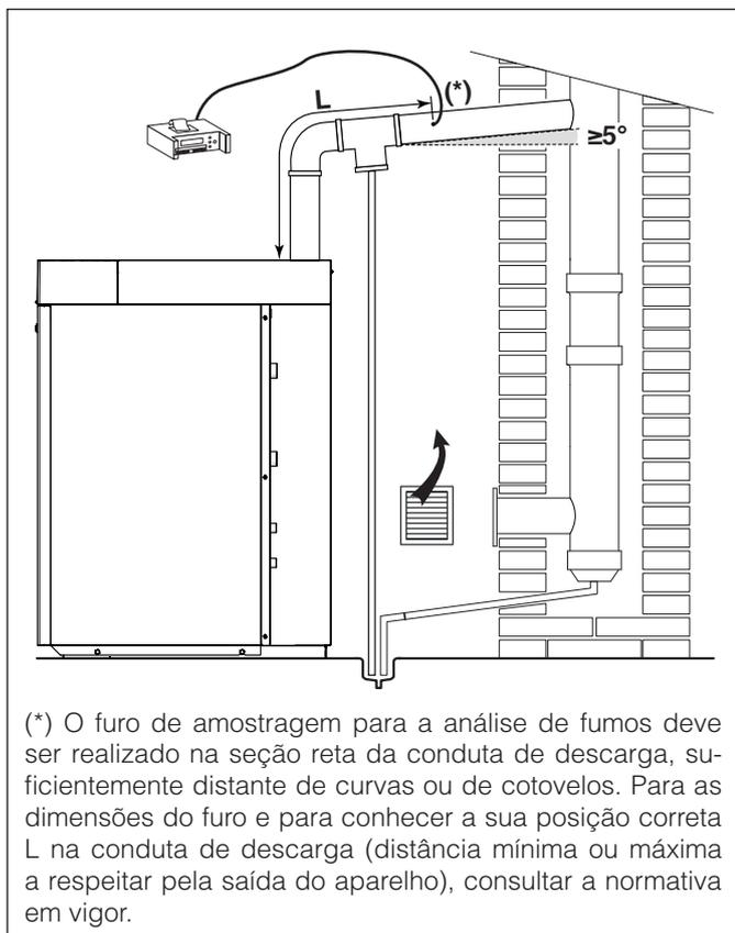
(\*) O furo de amostragem para a análise de fumos deve ser realizado na seção reta da conduta de descarga, suficientemente distante de curvas ou de cotovelos. Para as dimensões do furo e para conhecer a sua posição correta L na conduta de descarga (distância mínima ou máxima a respeitar pela saída do aparelho), consultar a normativa em vigor.
