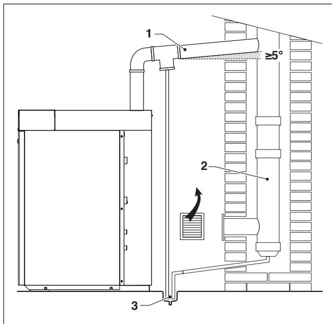
**!** O sistema de descarga de condensação (3) deve ser instalado de acordo com a legislação e os regulamentos locais em vigor.
