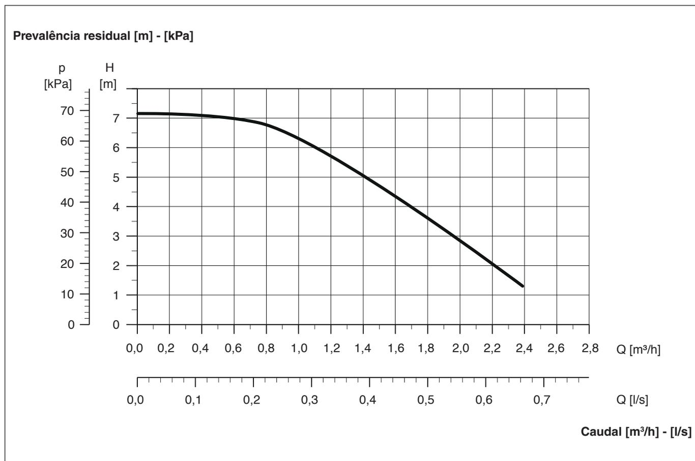
As curvas referem-se a uma densidade de 983,2 kg/m<sup>3</sup>, uma temperatura da água de +20 °C e a uma viscosidade cinemática de 0,474 mm<sup>2</sup>/s (0.474 cSt).
