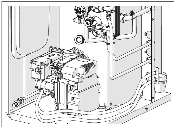
A conexão do tubo de ida da alimentação do gásóleo deve ser realizada diretamente no filtro (1) (acessório); já o tubo de retorno na conexão preparada (2).
