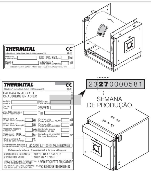
⚠ A alteração, eliminação, ausência das placas de identificação e outras que impeçam a identificação segura do produto, tornam difícil qualquer operação de instalação e manutenção.
