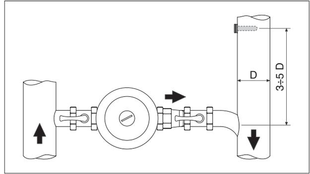
⚠ Para medir a temperatura efectiva de retorno no sistema, a fim de comandar a bomba anti-condensação ou gerir as funções de colocação em regime em sistemas de regulação térmica, é necessário colocar uma cápsula porta-sonda, antes (a montante) do ponto de engate hidráulico, a uma distância 3 a 5 vezes maior que o diâmetro do tubo de retorno.
